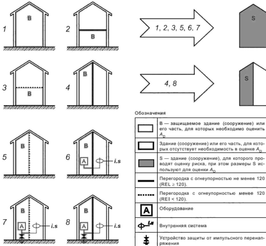
Рисунок А.4 — Защищаемое здание (сооружение), представляющее собой часть более крупного здания (сооружения)
