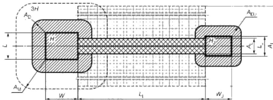
Рисунок А.5 — Области защиты (область покрытия) ( $A_D$ ,  $A_M$ ,  $A_L$ )
